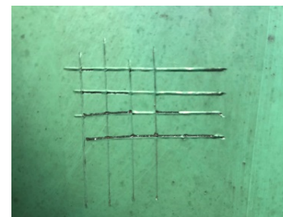
写真-6 碁盤目試験にて凝集破壊が未発生のブロック
