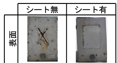
写真5 A-5塗装系供試体外観
