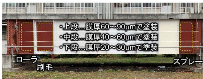
図1 廃桁の切出し部材の外観と施工箇所
