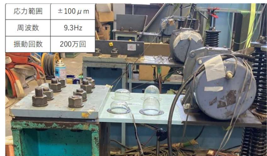
図-7 振動試験状況 (200 万回実施)
