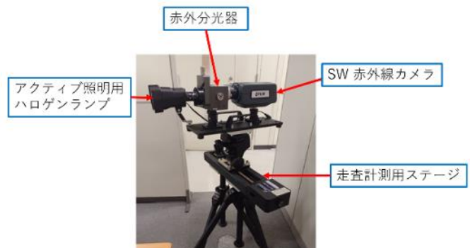
図 3 近赤外線ハイパースペクトルイメージングシステム
