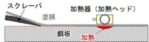
図-1 IH 塗膜除去工法の施工イメージ
