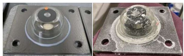
図-4 複合サイクル試験前後の試験体
