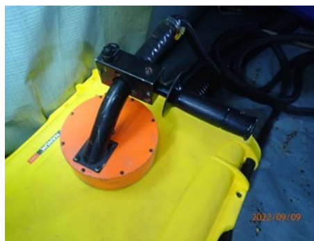
写真-1 IH塗膜剥離機「MEKURERU（メクレル）」
