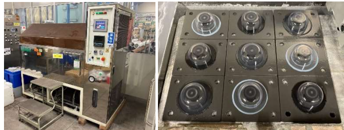
(a) 試験機 (b) 設置状況 図-3 複合サイクル試験
