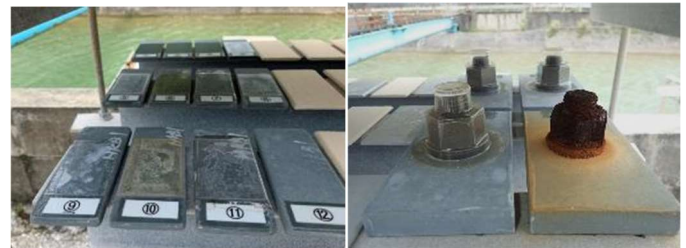
(a) フィルム (b) ボルトキャップ 図-1 過年度フィルム・キャップの暴露試験状況
