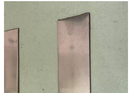
写真3. クリープ試験体接写
