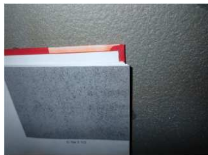
図-4 AWT 処理後の鋼素地の状況
